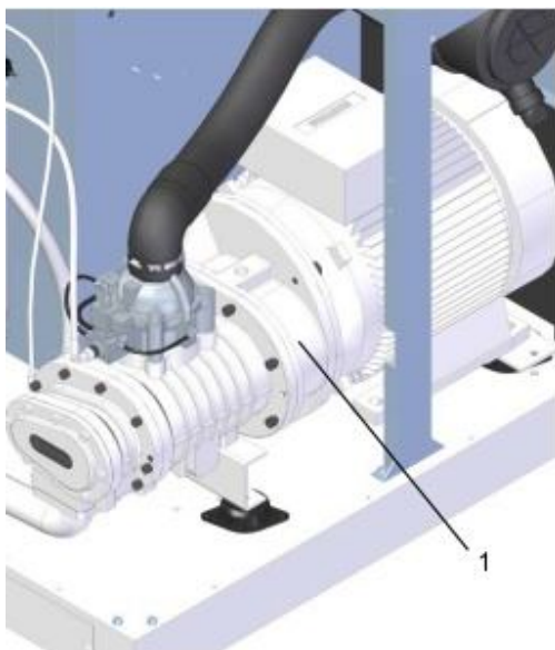
Рис. 5: Винтовой компрессор с приводом через редуктор
