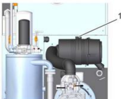
Рис. 36: Ослабить фиксатор всасывающего фильтра
